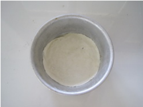
6. นำชิ้นยางออกจากจานไปทำการรีดให้เป็นแผ่นบาง โดยให้ความหนาไม่เกิน 2 มม.
